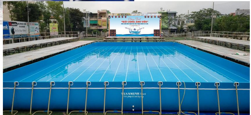
Bể bơi lắp ghép (bể bơi di động) được làm từ bạt PVC 5 lớp, bao gồm 2 lớp nhựa 1 lớp bố chịu lực, 1 lớp hoạt chất chống tia UV và 1 lớp chống nấm. Bạt được ép chín, gia công bằng máy chuyên dụng đảm bảo 100% không rò rỉ khí ra ngoài, có thể gấp gọn khi không có nhu cầu sử dụng.
